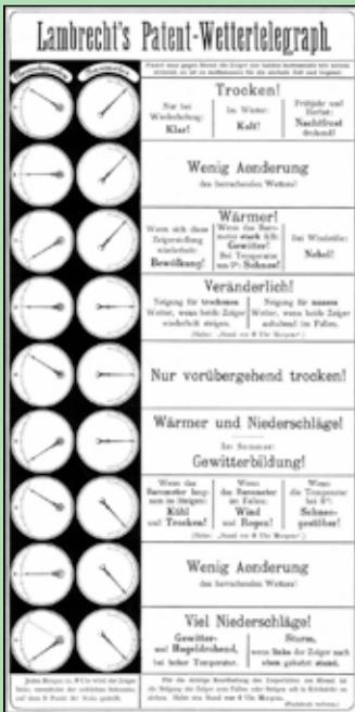
Vor der Post betreute der Verschönerungsverein eine Vitrine mit einem Wettertelegraphen der Firma Lambrecht (Göttingen). Lambrecht hatte 1881 dieses Instrument erfunden. Es besteht aus einem Thermohyroskop und einem Barometer, das eigene Wettervorhersagen ermöglichte (Schema links).
