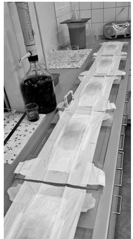
Im Laborbereich wird regelmässig die Flüssigkeitsaufnahme der Windeln getestet. Früher konnten Mütter die gebrauchten Windeln ihrer Kinder mitbringen. Wöchentlich gab's einen Testtag.
